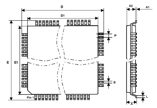
SAM9407 THIN PLASTIC 144 LEAD QUAD FLAT PACK (TQFP144)
